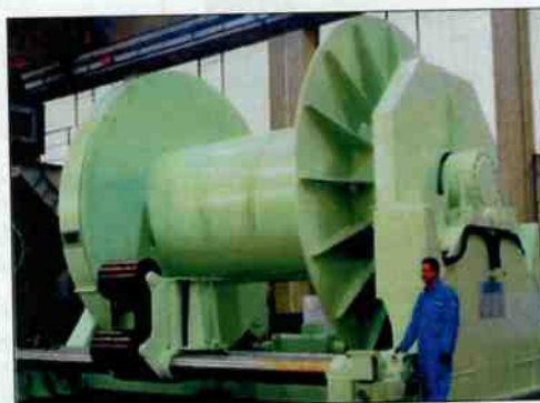
Перемотчик для машин натяжки с барабаном подтягивания и сброса 200кН - Saipem Italia
