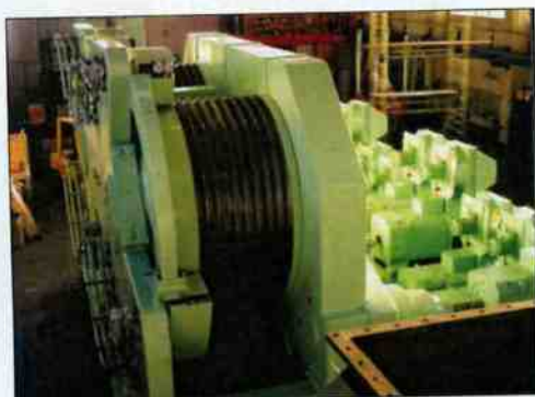
Машина натяжки с барабаном подтягивания и сброса 5500кН Saipem Italia
